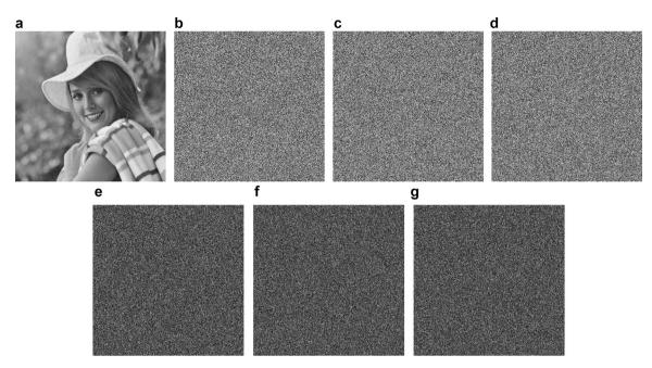
**Fig. 12.** Key sensitivity analysis in the encryption process: (a) plain-image *P*; (b)  $C_1 = \text{Enc}(P, K_1)$ ; (c)  $C_2 = \text{Enc}(P, K_2)$ ; (d)  $C_3 = \text{Enc}(P, K_3)$ ; (e)  $|C_1 - C_2|$ ; (f)  $|C_1 - C_3|$ ; (g)  $|C_2 - C_3|$ .
